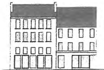
Suppression ou insuffisance de pilier à l'angle de deux rues.
